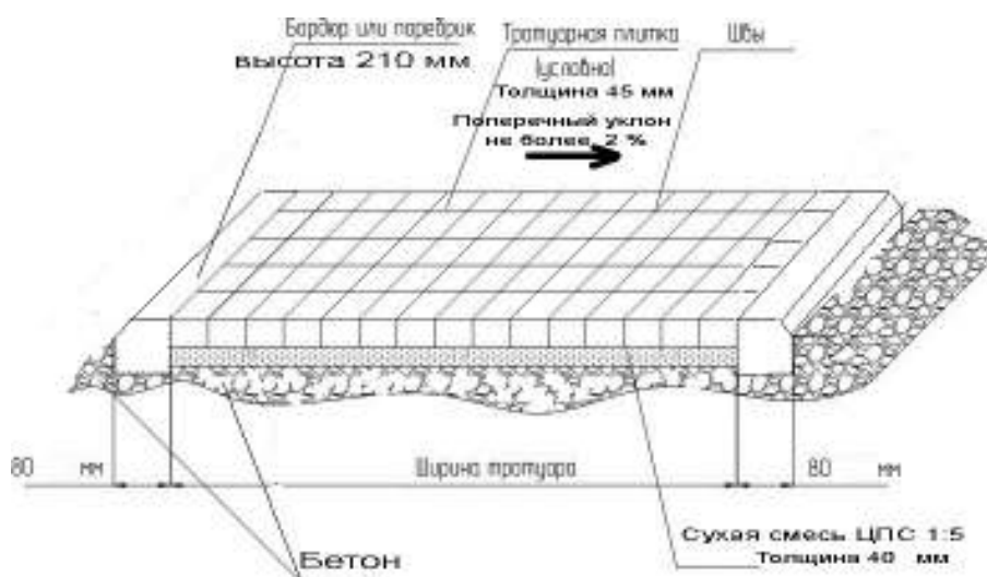
Разбивочный чертеж пешеходных дорожек из тротуарной плитки (разбивочный чертеж и схема)
