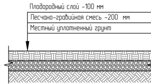
Конструкция покрытия откоски (тип 3)
