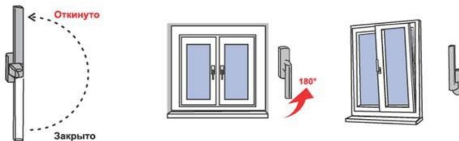
Для запираения створки из открытого или откидного положения ее сначала закрывают и, придерживая створку рукой, поворачивают ручку вертикально вниз (положение «Закрыто» на Рис. 2).
