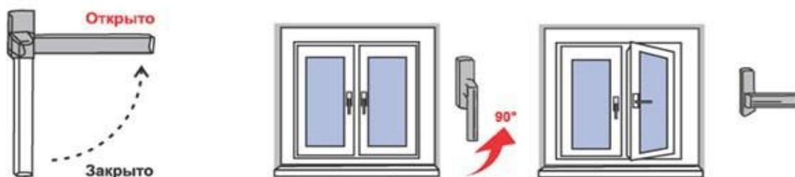
Для перевода створки из закрытого положение в откидное (поворот створки относительно нижней горизонтальной оси, положение «Откинута» на Рис.2) ручку поворачивают вертикально на 180 градусов вверх, затем, потянув за ручку, поворачивают створку относительно нижней горизонтальной оси на заданный изготовителем угол (не более 10 градусов) (откидной режим).
